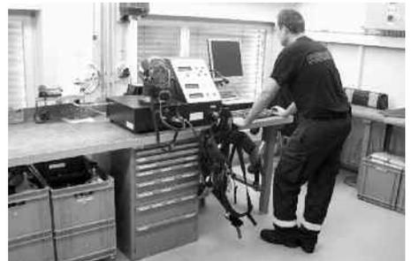
Überprüfung einer Atemschutz-Trageinheit.
