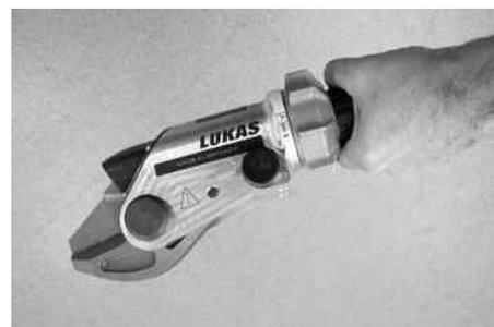
Kleine Hydraulischere für den Tech Zug.
