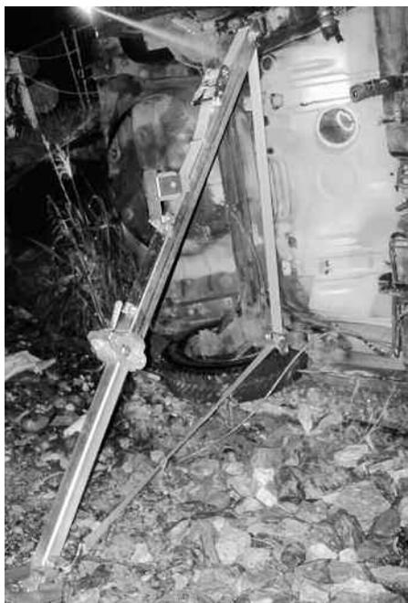
Dreieckstütze zur Sicherung von Fahrzeugen.
